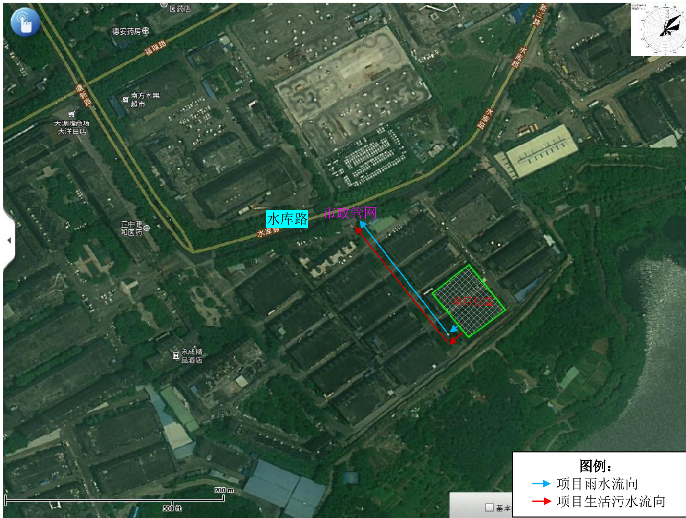
附图 13 项目排水管线平面布置及排水路径示意图
