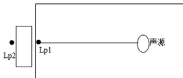
图 4-2 室内声源等效为室外声源图例
