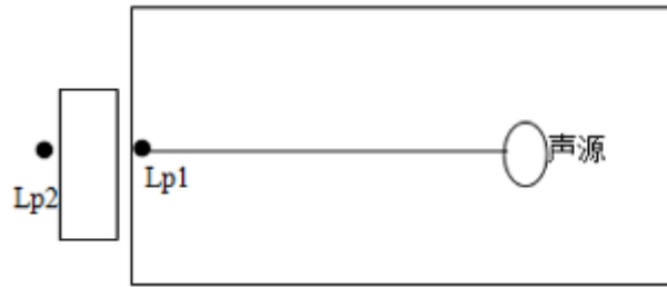
图 4-3 室内声源等效为室外声源图例
