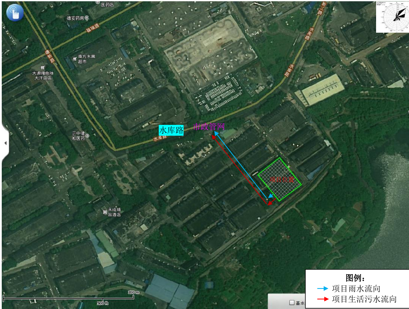
附图 13：项目排水管线平面布置及排水路径示意
